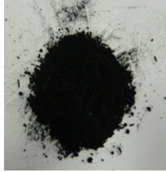
A: Kordbezi iplik parçaları, B: Karbonsiyahı ve inorganik katı dip ürün, C: lastik parçaları ve mazotla yapılan conta
