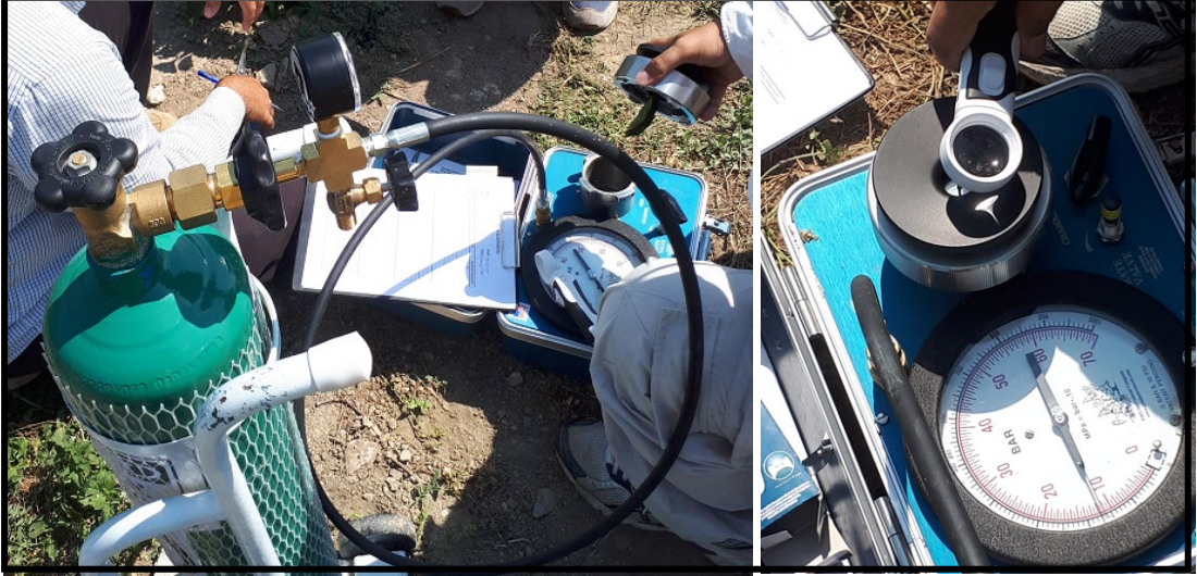
Şekil 2. Yaprak su potansiyeli ölçümü
