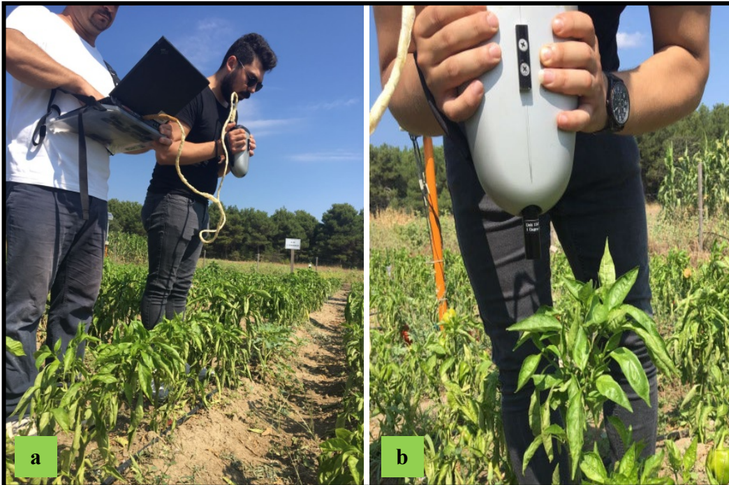
Şekil 3. Spektrometre ile taç düzeyinde ölçüm (a) ve yaprak düzeyinde ölçüm (b)
