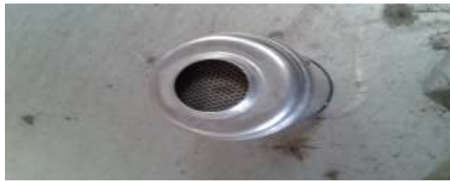
Şekil 7. Konvertör uç kapağı
