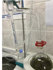
e) Clevenger aparatı ile uçucu yağ eldesi
