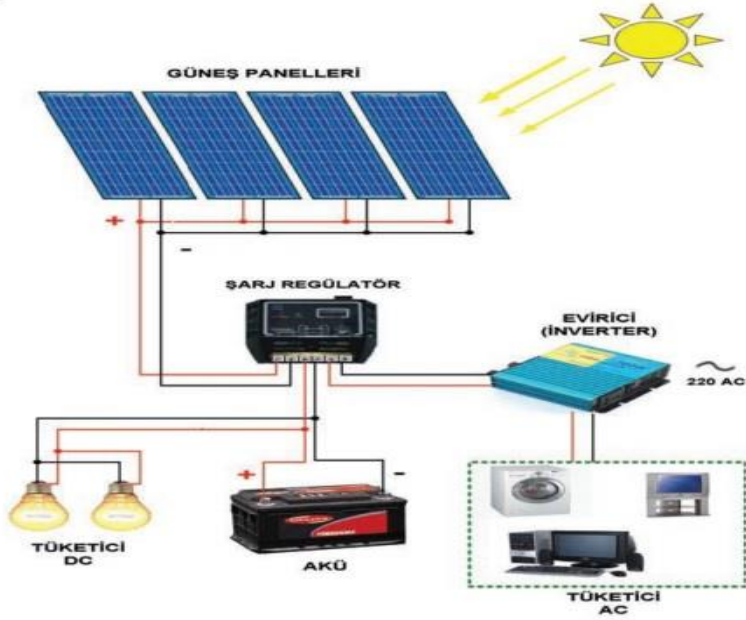
Şekil 1. Şebekeden bağımsız bir sistemin şematik gösterimi (Koroğlu ve ark., 2010)
