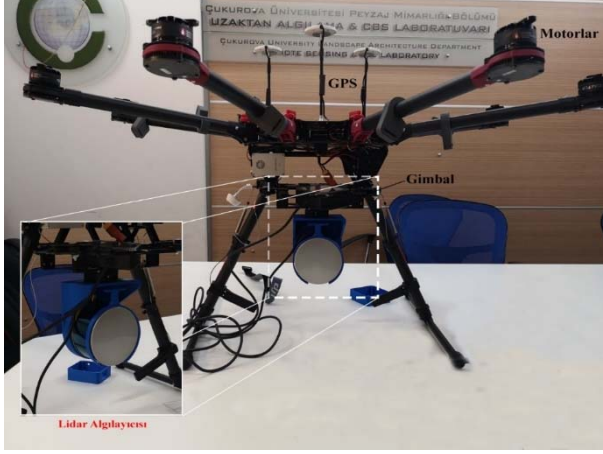
Şekil 6. İnsansız hava araçlarında lidar algılayıcılar
