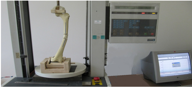
Şekil 2: Lloyd LR 5K vertikal yüklenme test cihazı
