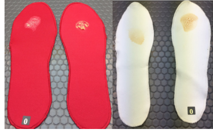
Şekil 4: Nano gümüş emprenye edilmeyen [0] kodlu şahit kumaş ve nano gümüş emprenye edilen örnek kumaşta 24 saat sonraki görüntüleri
