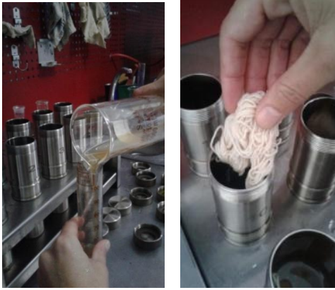
Şekil 2. Çözelti ve ipliklerin test tüplerine aktarımı (Aydın, 2018)
