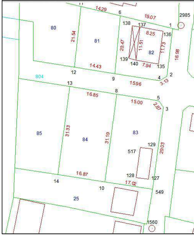
Fig. 8: Parsellerin ve diğer detayların Netcad ortamındaki kenar ölçü değerleri.
