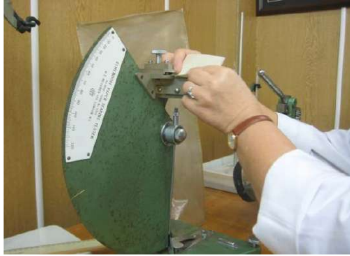
Fig.12. Kağıt örneklerinin Elmhendorf kağıt yırtılma testi cihazına yerleştirilmesi.
