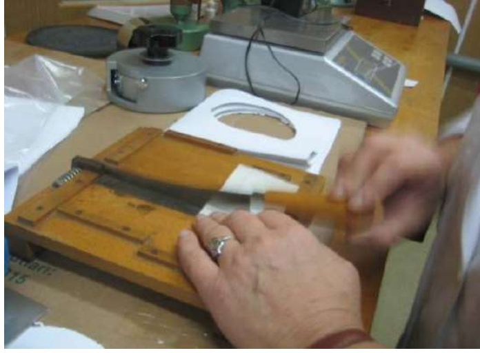
Fig.11. Giyotin ile kağıt örneklerinin kesilmesi.
