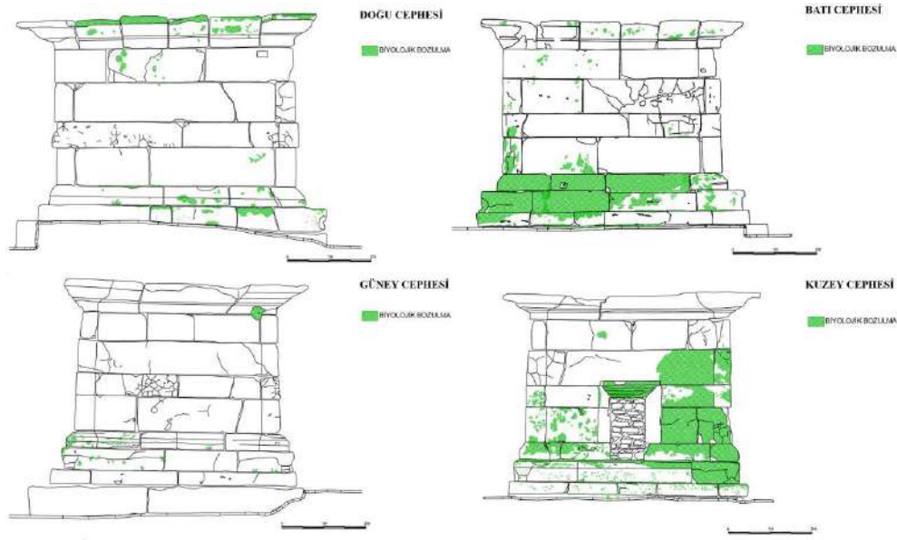
Fig. 1: Cephelerde yapılan görsel biyolojik bozulma haritaları.
