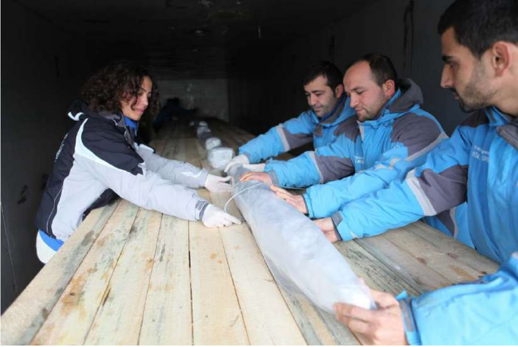
Fig 3 Kağıt havlu ve plastik folyo ile sarılarak fırına yerleştirilen YK 3 ahşapları.
