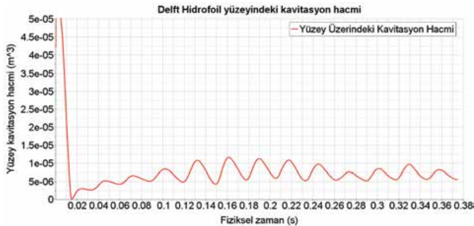
Şekil 9. Hidrofoil yüzeyinde kavitasyon hacminin zaman ile değişimi (Durum 1).
