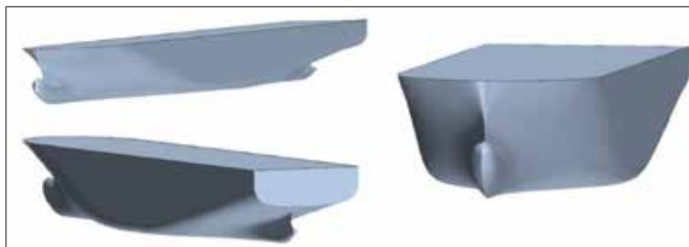
Şekil 2. DTC tekne formu üç boyutlu CAD geometrisi.
