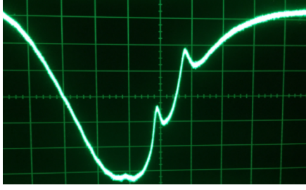
Şekil 4. Cs1 küvetinde Doppler soğurumu spektrumu üzerinde Doppler soğurum içi rezonansların osiloskop ekranındaki görünümü
