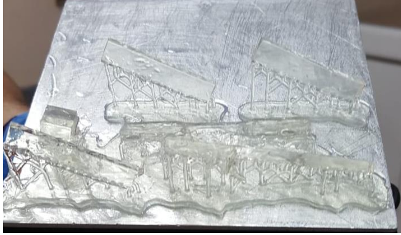
Şekil 2. Basımı tamamlanmış 3B Nanokil Takviyeli Deney Numunesi
