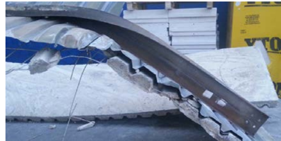
Şekil 11. Deney sonrası kirişin mesnet bölgesinin görünümü
