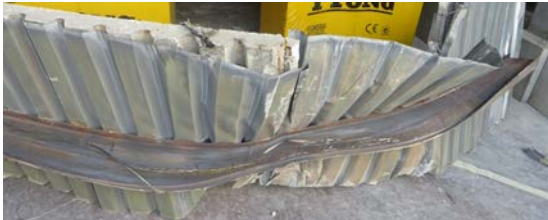
Şekil 10. Yanal burulmalı burkulma göçme modu
