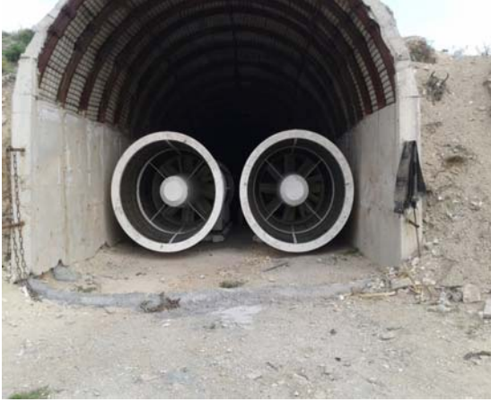
Şekil 2. Ocak hava çıkış desandrisi
