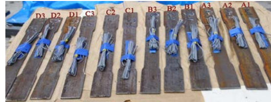
Şekil 3. IPE 140 çelik profil için çekme numunelerinin üzerine şekil değiştirme ölçerlerin (strain gauge) yerleştirilmesi.
