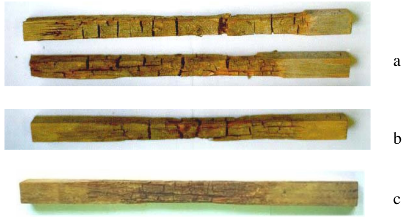
Şekil 6.a). Mazeks ile emprenye edilmiş sarıçam örnekleri üzerinde kahverengi çürüklük oluşumu. b) Sarıçam emprenyesiz kontrol numunesinde kahverengi çürüklük oluşumu, c) Kızılağaç örneğinde toprak zonunda çürüklük.
