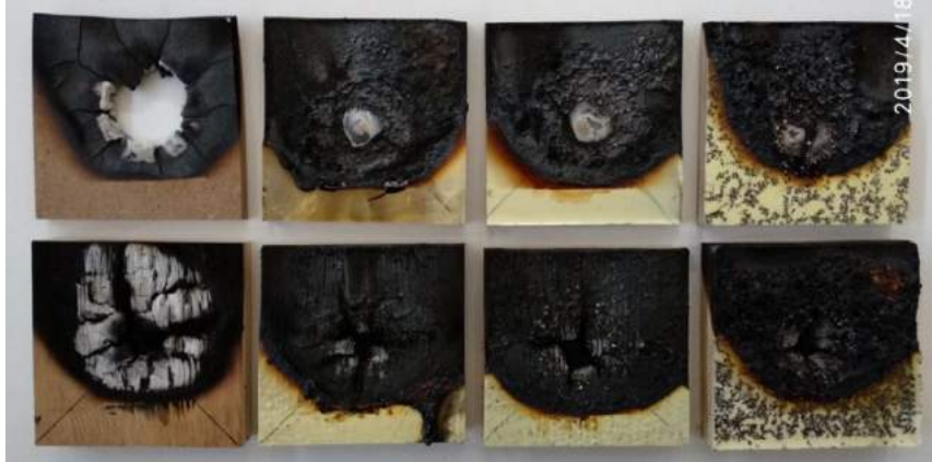
Şekil 9. Vermikülit katkılı poliüretan kaplı ahşap kompozit malzemelerin yanma davranışları
