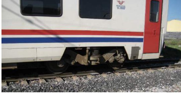
Şekil 1. TVS 2000 Serisi vagonlarını taşıyan Y32 Bojisi [12]
