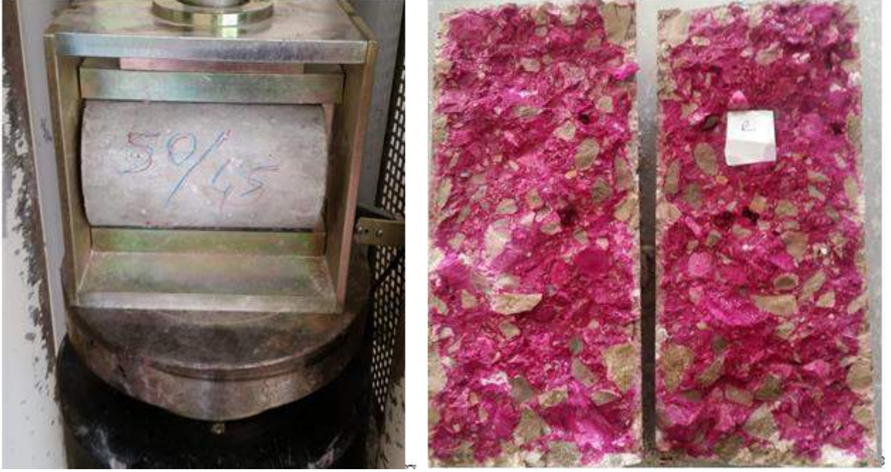
Şekil 3. Karbonatlaşma deneyi, numunelerin ortadan ikiye ayrılması, Phenolphtalein (fenol fitalein) çözeltisi püskürtülmesi.
