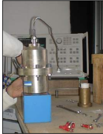
Şekil 5. ASTM D 4935-89 standardına göre geliştirilmiş NBS test düzeneği
