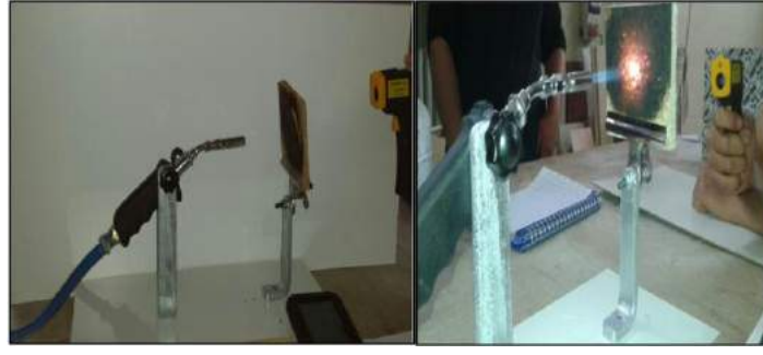
Şekil 5. Kütte kaybı ve ısı geçirgenlik test düzeneği
