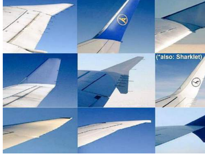
Şekil 1. Değişik şekil ve tiplerde kıvrık kanat ucu tasarımı[2]
