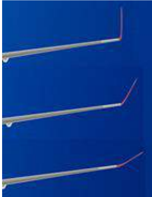
Şekil 2. Başkalaşan kanat ucu tasarımının çalışması [3]
