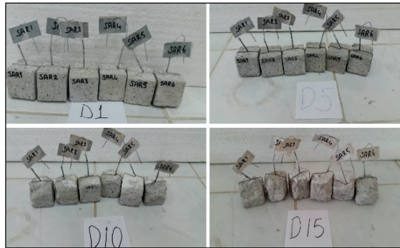
Foto 5. Sodyum sülfat dekahidrat çözeltisinde 1, 5, 10, ve 15. periyotlardaki Ayazini tüfü numunelerinin görünümü.
