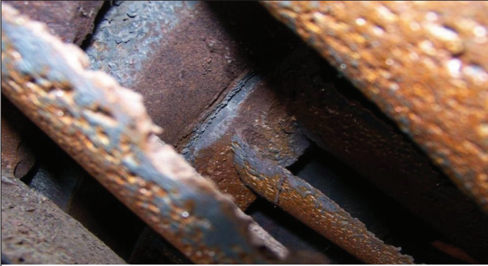
Şekil 7. Sıcak korozyona maruz kalmış türbin kanadı [20]
