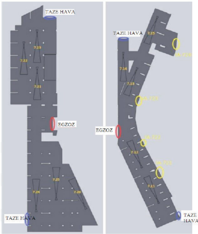
Şekil 1.2. Jet fan, taze hava ve egzoz menfezleri yerleşimlerinin gösterimi
