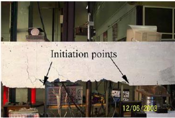
Şekil 14. S3b beton kirişinde CFRP kopma bölgesi
