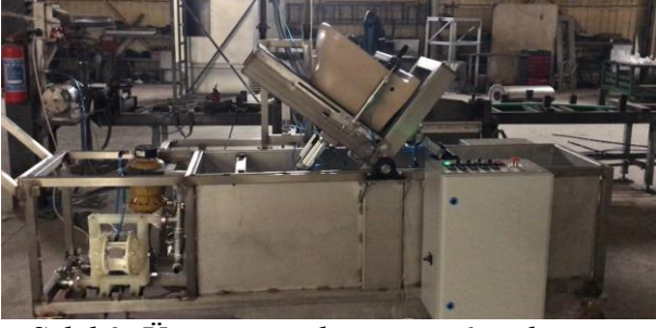
Şekil 9. Üretimi yapılan seramik sırlama ve çalkalama makinesi
