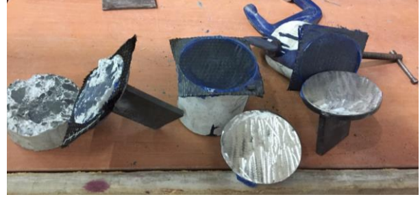
Şekil 5. Sırasıyla soldan F, B ve B tipi kopma modları
