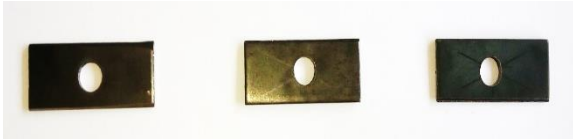
1 nolu numune: DN1 Boyutlar 50x20x2 mm d = 9 mm 2 nolu numune: DN2 Boyutlar 50x20x2 mm d = 9 mm 3 nolu numune: DN3 Boyutlar 50x20x2 mm d = 9 mm
