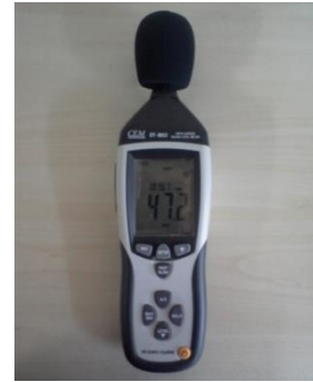
Şekil 2. CEM DT-8852 model gürültü ölçüm cihazı (CEM DT-8852 sound level meter)
