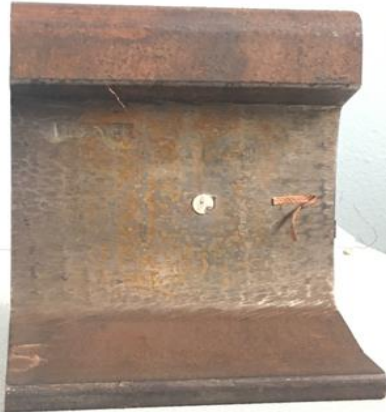
Şekil 2. Piezoelektrik sensör eklenmiş ray (Piezoelectric sensor attached to the rail steel)
