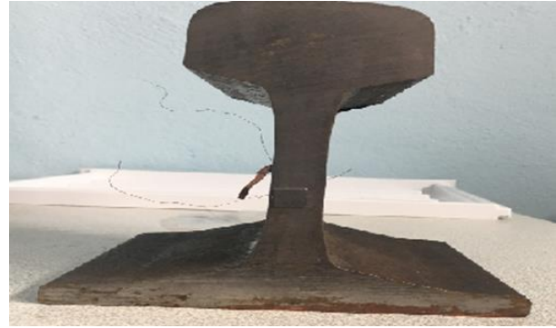
Şekil 3. Mıknatıs yardımıyla kablonun ray çeliğine eklenmesi (Attaching the cable to the rail steel using a magnet)
