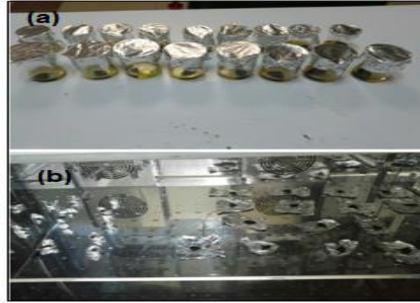
Şekil 8. odun-biyoplastik kompozitlerinin (a): 0.5 M'lık NaOH çözeltisine maruz bırakılması ve (b): sonrasında kurutulması
