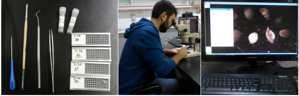
Şekil 3. Sedimanların içindeki fosillerin ayrılmasında, depolanmasında kullanılan araçlar, mikroskop ve fosillerin dijital fotoğraflanmasında kullanılan Kameram yazılımının arayüzü.
