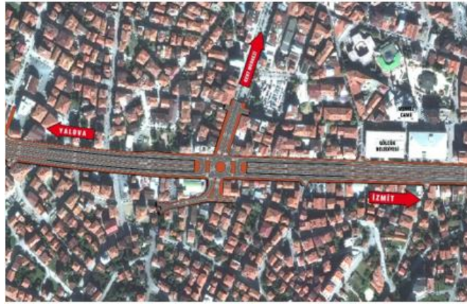
Şekil 12. Farklı Seviyeli Kavşak (Dal-Çık) Projesi
