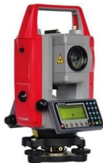
Şekil 2. Pentax R-1505N elektronik takeometre
