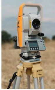
Şekil 3. Cygnus topcon ks-102 elektronik uzaklık ölçer
