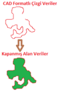
Şekil 2. CAD çizgi-alan geometri dönüşümü
