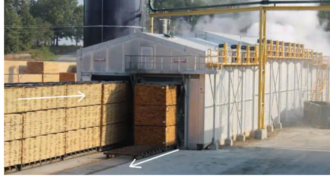
Şekil 4. İstifleri zıt yönde ilerleyen kesintisiz fırın çeşidi (URL4 2019). (A Counter flow kiln type that stacks moving opposite directions).
