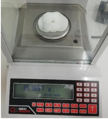
Şekil. 5 Hassas terazi ile kütle kayıplarının ölçümü
