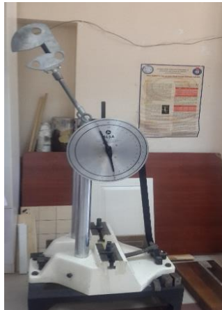
Şekil 2. Eğilme direnci, eğilmede elastikiyet modülü, dinamik eğilme direnci ve statik sertlik tayini direncinin belirlenmesinde kullanılan test makinesi ve deney numunelerinin görünümü.
