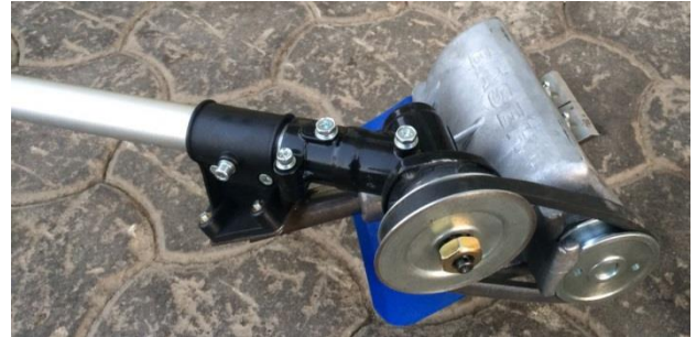
Şekil 5. Kabuk soyma ekipmanının şafta bağlanma açısı ve şekli
