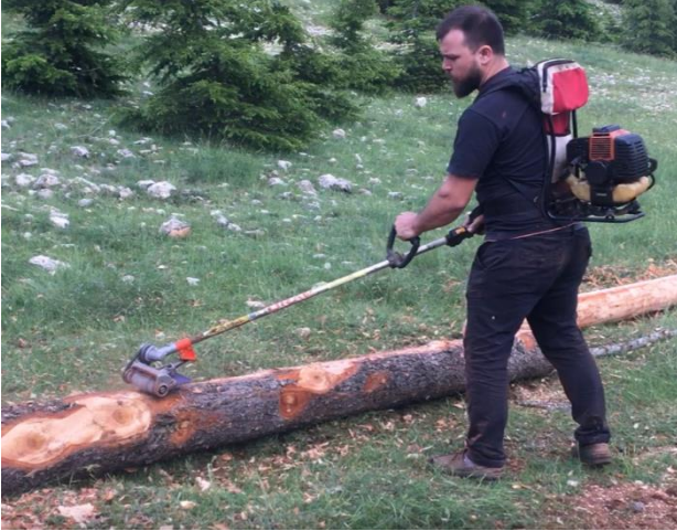
Şekil 6. Motosoyarla tomruk soymada operatörün çalışma postürü
