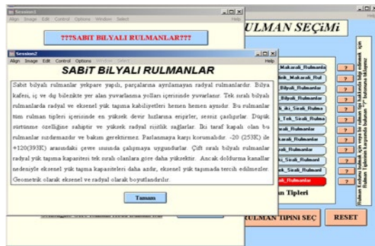
Şekil 13. Sabit bilyeli rulmanlar hakkında açıklama (Description of deep groove ball bearings)
