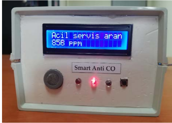
Şekil 9. CO Gaz Yoğunluğunun 800 ppm'in Üstünde Olması Durumu
