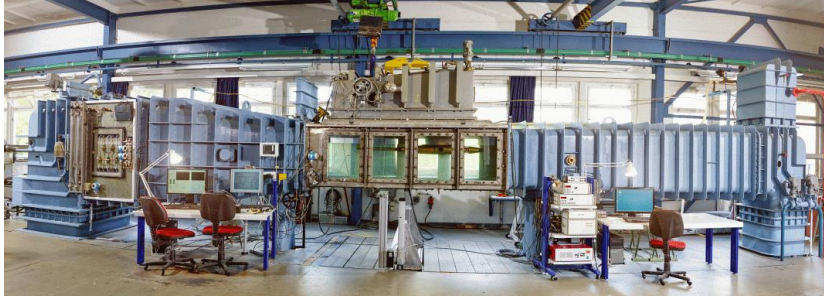
Şekil 15: SVA Potsdam Kaviteasyon Tüneli ve Test Kesiti (260 cm x 85 cm x 85 cm) (SVA, 2019).
