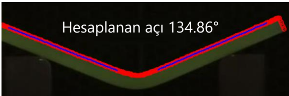
Şekil 5: 12 mm kalınlığındaki plaka için eşikleme yöntemi ile açı hesaplaması.
