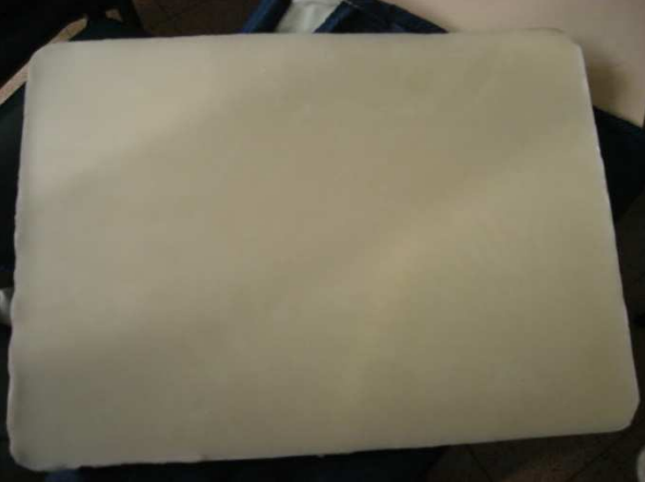
Resim 10: Karbon partiküllerinden geçirilerek temizlenmiş temel petek
