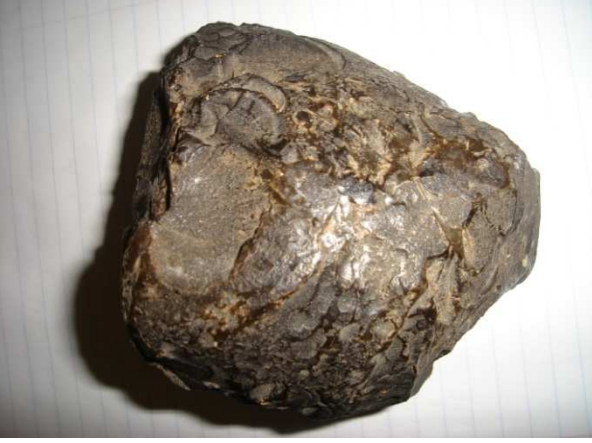
Resim 9: Basınç altında karbon partiküllerinden geçirilmiş balmumundan arda kalan depozit.
