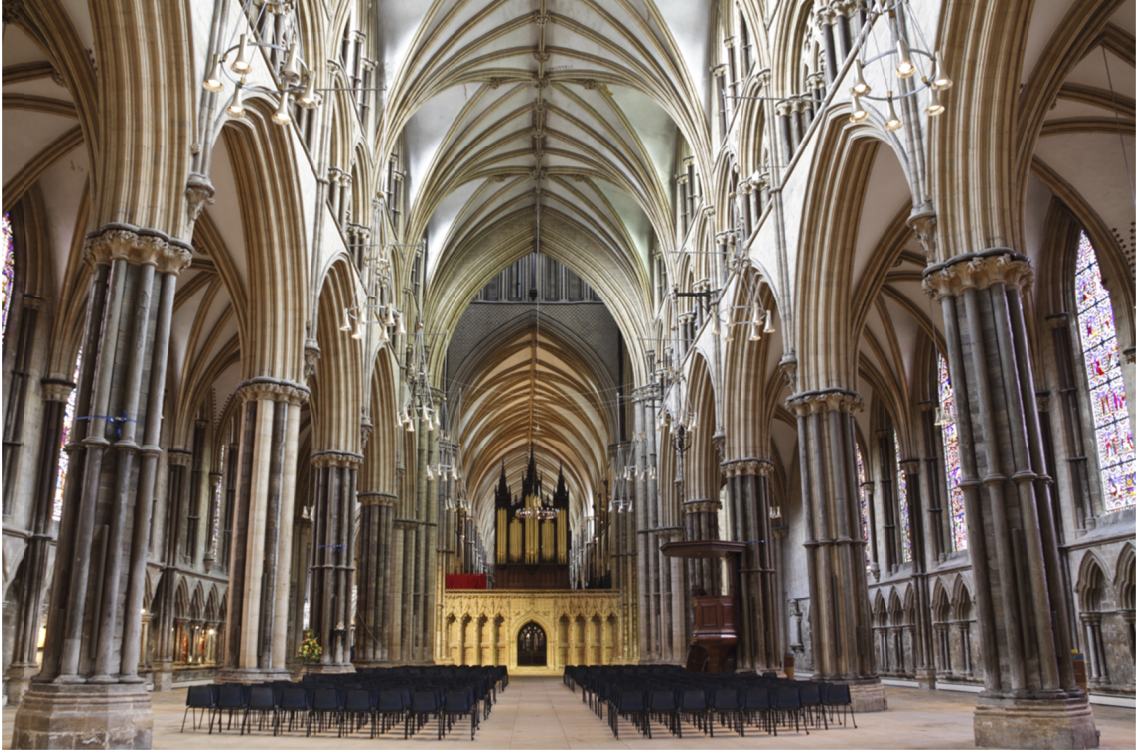
Görsel 3. İç yapıdaki Gotik Katedralde bölümlerin bir sisteme göre düzenlenme ilkesine uygun kemer, kaburga tonozların bir akış içinde sıralanışı ve ayırt edilebilmeleri (URL 4).
