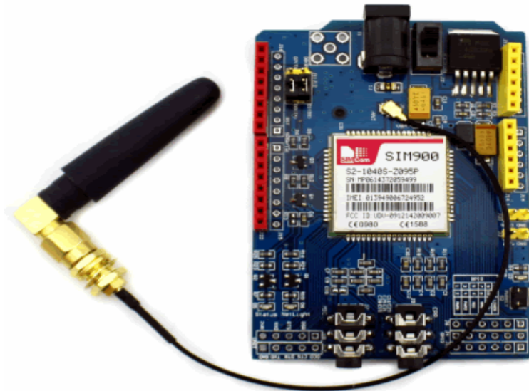
Şekil 5. SIMCom SIM900 GSM/GPRS modülünün donanımsal yapısı
