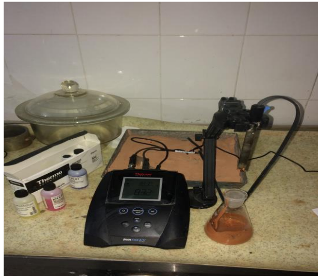
Şekil 3. PH ve elektrik iletkenlik ölçüm cihazı
