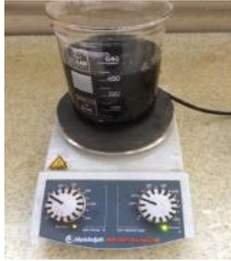
Şekil 2. Nano-CuO katkıli kompozit kilin hazırlanışı
