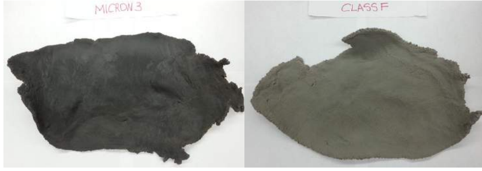
Şekil 3. Mikserleme ve çift merdaneli hadde sonrası numunelerin fotoğrafları.
