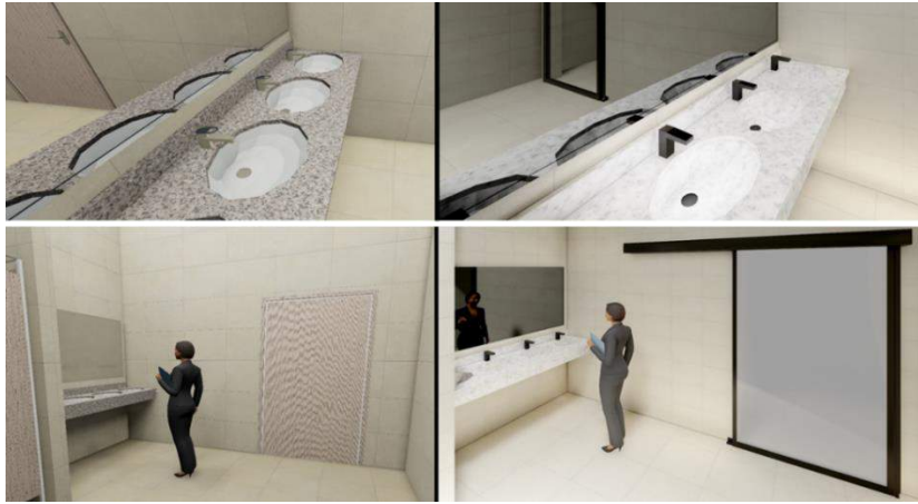
Şekil 21. Genel ıslak mekânlara önerilen harekete duyarlı batarya ve kapı önerisi
