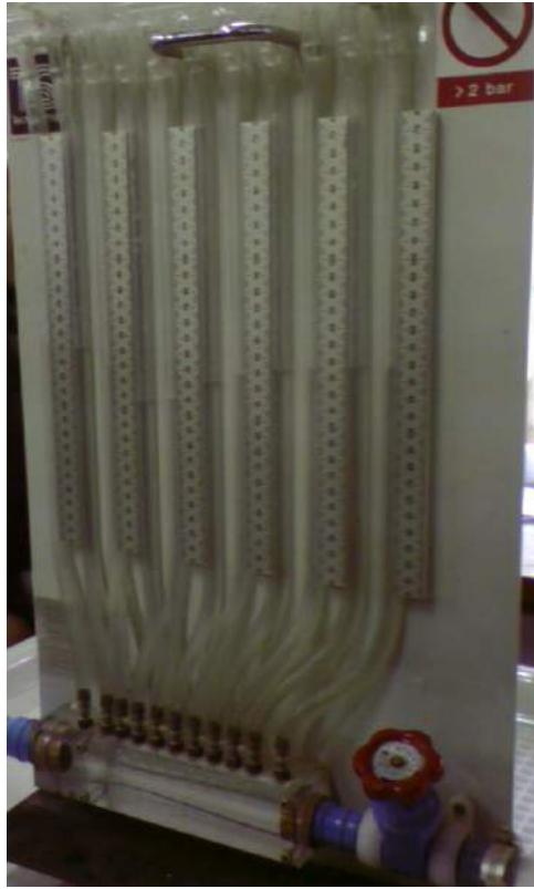
Şekil 5. Deneyde kullanılan venturimetre deney düzeneği ve piyezometre tüpleri.
