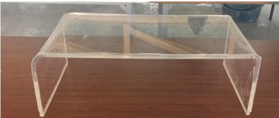
Şekil 2. Deneylerde kullanılan iki farklı geniş başlıklı savak modeli
