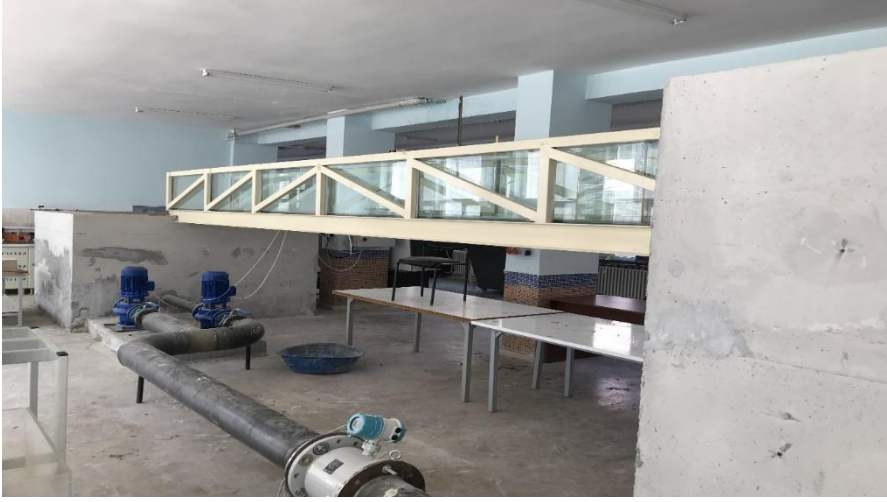
Şekil 1. Açık kanal deney düzeneği genel görünümü
