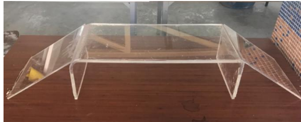
Şekil 2. Deneylerde kullanılan iki farklı geniş başlıklı savak modeli
