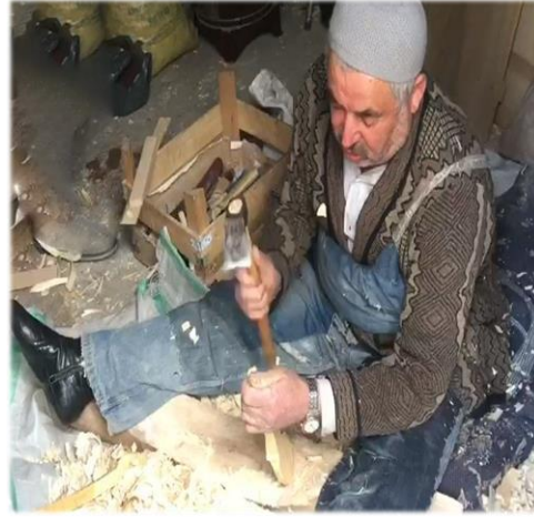
Fotoğraf 11: Keser aracılığı ile yapılmak istenen kaşığın ebadına uygun olarak küçültme/taslama
