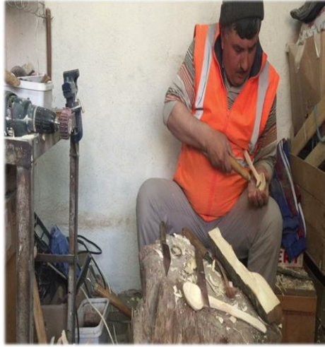
Fotoğraf 14: Eydü/eygi yardımı ile kaşığın tabla kısmını ağıza uygun inceliğe getirme.
