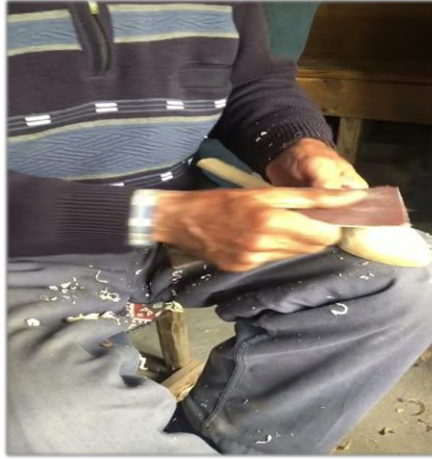
Fotoğraf 15: Zımpara yardımıyla kaşığı pürüzsüz hale getirme
