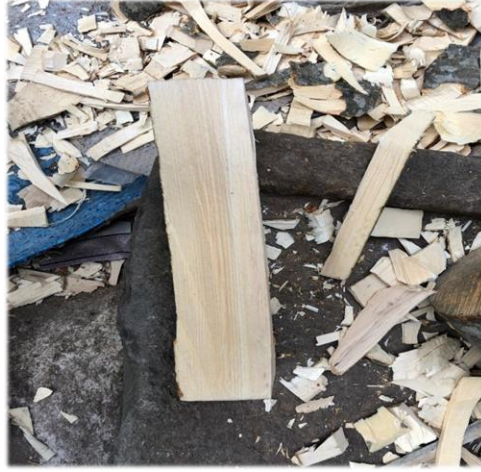
Fotoğraf 10: Balta ile kesilmiş fasaltak/takalak
