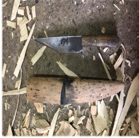
Fotoğraf 6: Nispeten kaba yontma işlemi için kaşık bıçağı
