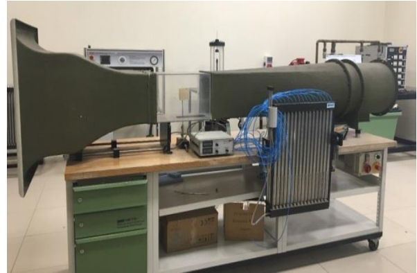
Şekil 6. Açık çevrimli rüzgâr tüneli (Open loop wind tunnel)
