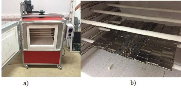
Şekil 2. Tavlama işlemi ortamı a) Elektronik kontrollü fırın b) Tavlanan deney numuneleri (The environment of annealing process a) Electronic controlled furnace b) Annealed test samples)
