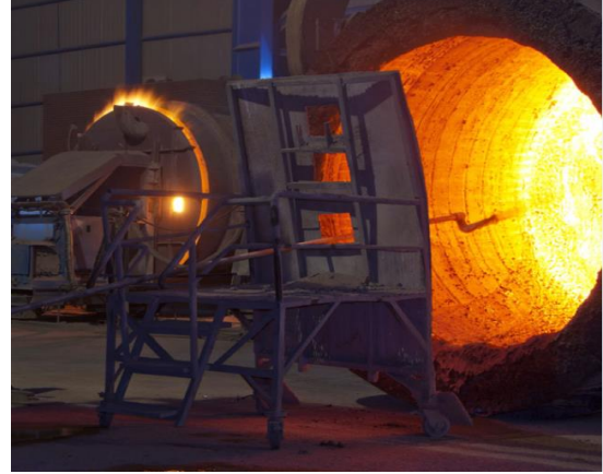
Şekil 1. Pota ocağı (Ladle furnace) [12]
