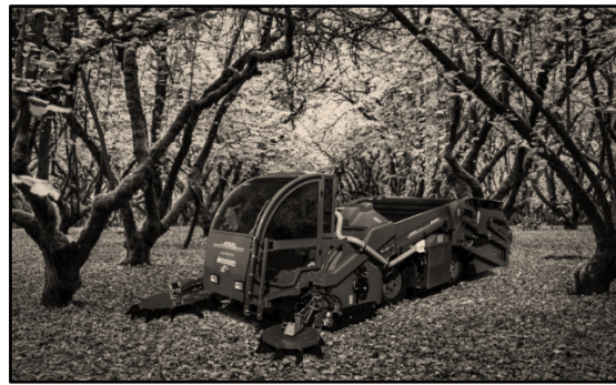
Şekil 8. ABD fındık bahçelerine uygun olarak tasarlanmış kabinli bir fındık hasat makinası
