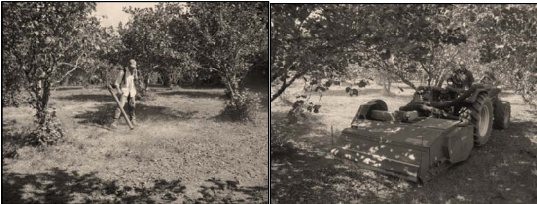
Şekil 6. İtalya'da fındığın sırtta taşınır üfleyiciyle namlu yapılması ve mekanik toplama ünitesi hasat makinasıyla toplanması (Zimbalatti et al. 2012).
