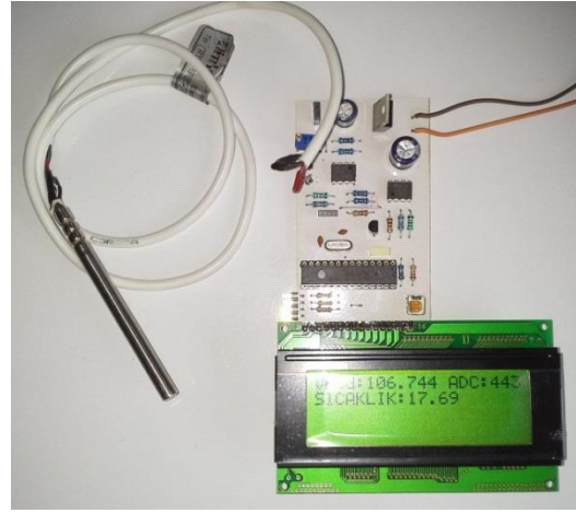
Şekil 10: PT100 bağlı sistemin test edilmesi
