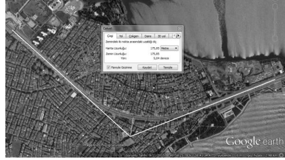
Şekil 9. Yarıçapı bilinmeyen bir yatay kurba ait bisektris uzunluğunun ve açısının Google Earth Pro programı üzerinden okunması (Reading the external distance and the deflection angle of a horizontal curve from Google Earth Pro where the radius is unknown)
