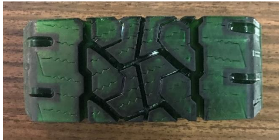
Figure 8. Pictorial view of tire tread pattern produced by Anycubic Photon S model three dimensional printer (Anycubic Photon S model üç boyutlu yazıcıda üretilen lastik sırt deseninin şematik görünümü)
