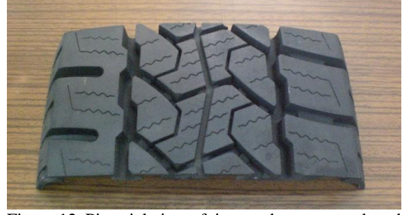
Figure 12. Pictorial view of tire tread pattern produced by ZPrinter 650 model three dimensional printer (ZPrinter 650 model üç boyutlu yazıcıda üretilen lastik sırt deseninin görünümü)
