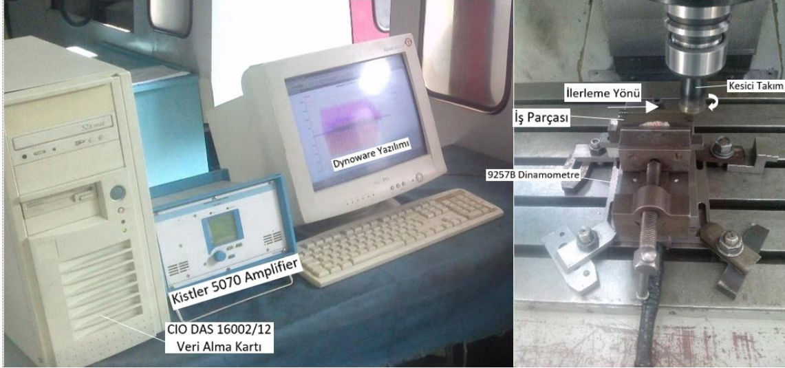
Şekil 3. Deney düzeneği ve kesme kuvvetlerinin ölçümü (Experimental setup and measurement of cutting forces)
