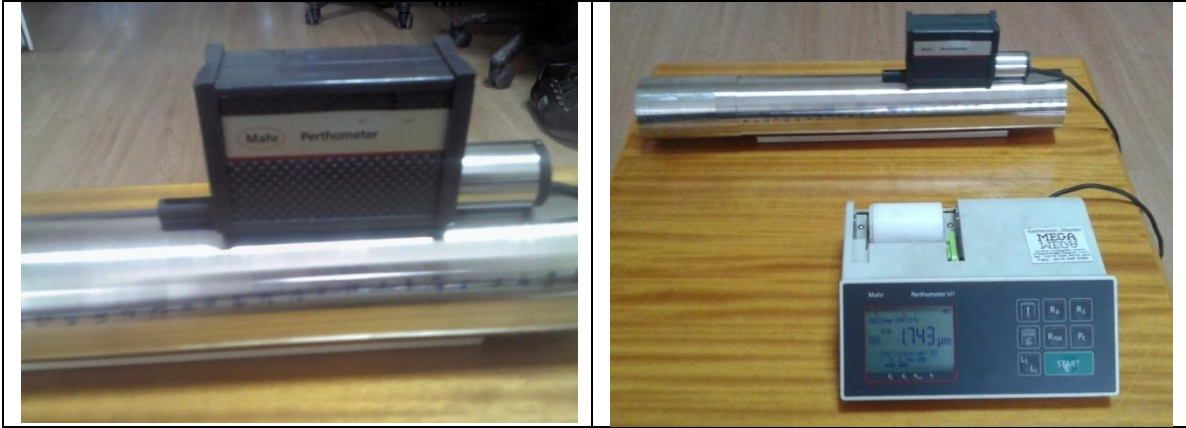
Resim 1. Perthometer M1 masa tipi yüzey pürüzlülük ölçme cihazı (Perthometer M1 table type surface roughness measuring device)
