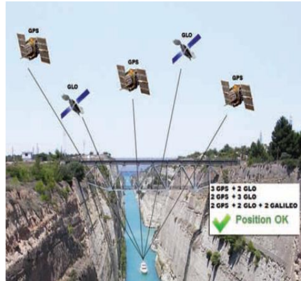
Şekil 6. Ashtech ProMark 800 Küresel Uydu Seyrüsefer Sistemi Alıcısı Çoklu Uydu Sinyalleri (Spectra Precision 2013).
