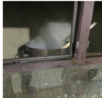
Şekil 3: Kral suyuyla altın ramatı reaksiyonunun gerçekleştiği kazan
