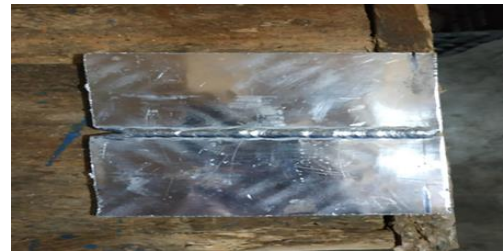
Şekil 1. TIG kaynak yöntemiyle birleştirilmiş levhaların görüntüsü.
