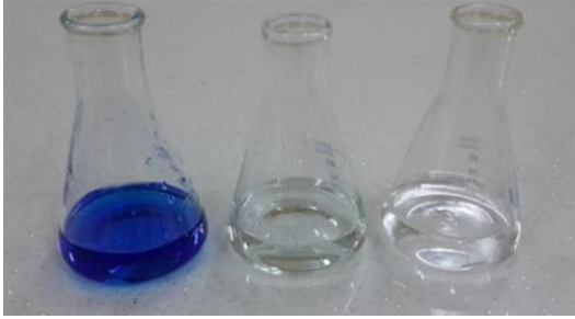
Şekil 15. 25 mg/L MM başlangıç kons. (soldaki), 1 g/L ZnO ile pH 9'da arıtılmış su (ortadaki) ve 1 g/L TiO 2 ile pH 2.5'te arıtılmış su (sağdaki).
