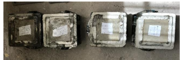
Şekil 4. Kalker agregası ile hazırlanan numuneler
