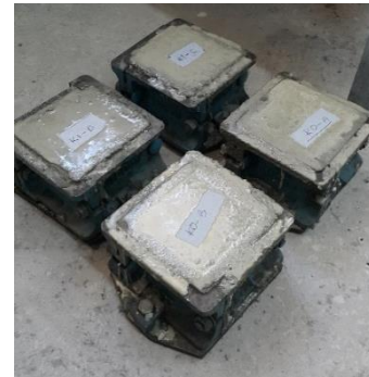
Şekil 3. Metagabro agregası ile hazırlanan numuneler
