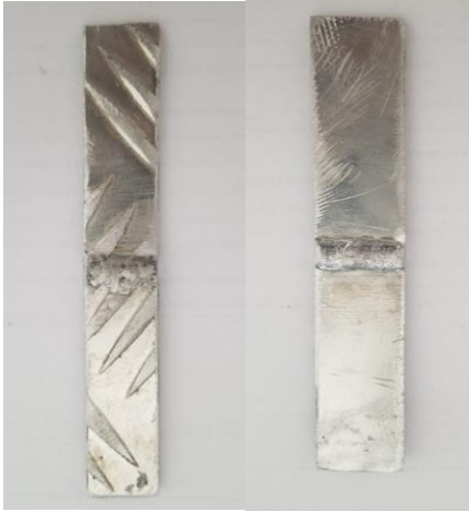
Şekil 2. Çekme testi için hazırlanan numuneler.
