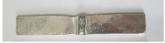
Şekil 3. Çekme testi sonrası numune.
