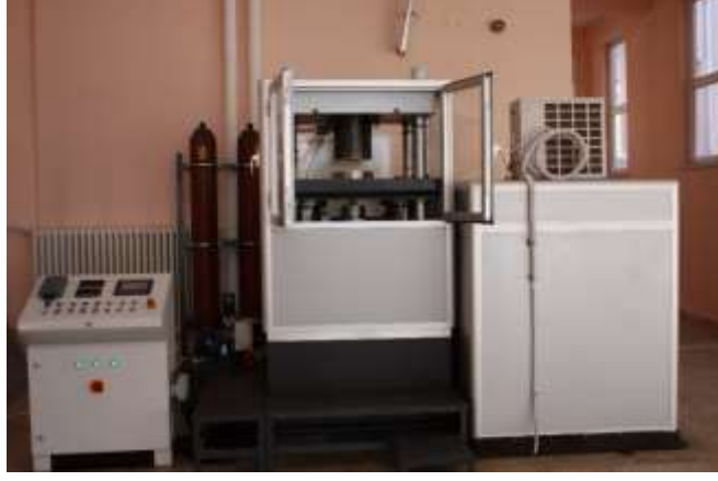
Şekil 5. Çalışma kapsamında kullanılan hidroşekillendirme presi Figure 5. Hydroforming press used in current study
