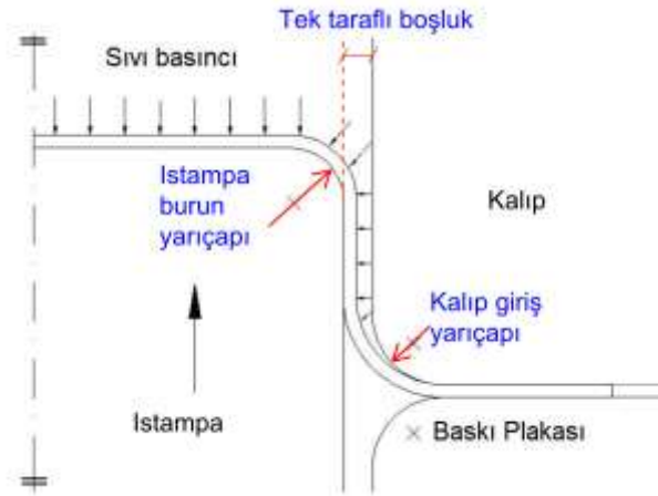
Şekil 1. Hidromekanik derin çekme prosesi (Akay ve diğ., 2014)
