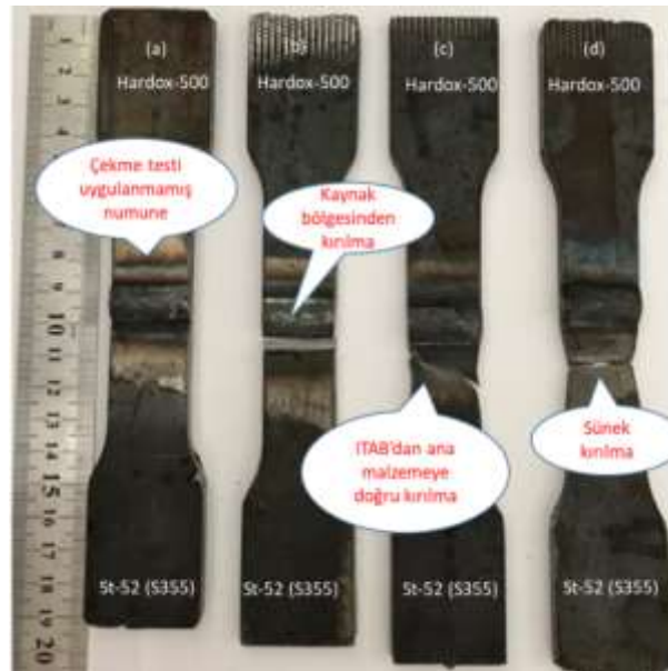
Şekil 6. (a) 200 A ve 27,8 V, (b) 180 A ve 26,6 V, (c) 180 A ve 27,2 V, (d) 180 A ve 27,8 V koşullarında elde edilen numuneler
