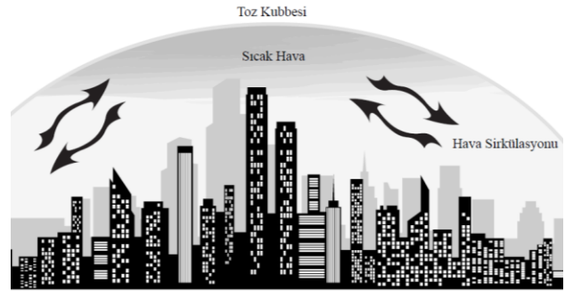
Şekil 2. Miller 1991 ve Akay 1996'dan geliştirilerek kentsel ısı adası oluşumu
