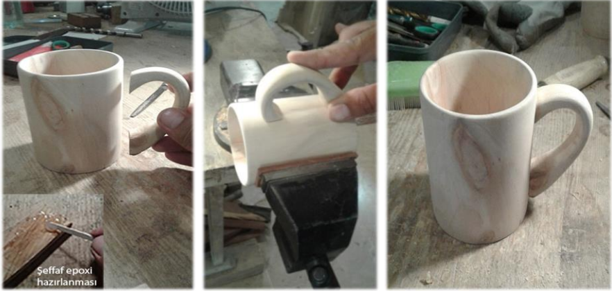
Görsel-17: Kulpun yapıştırılması ve tamamlanmış söğüt bardak.
