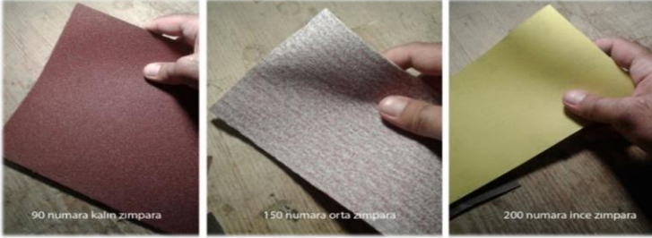
Görsel 14. Zımparalama işleminde kullanılan zımpara türleri.
