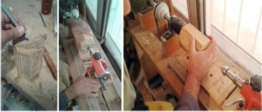
Görsel-8: Parça merkezinin işaretlenmesi ve tornaya bağlanması.
