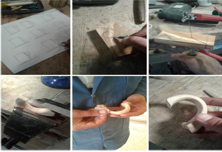
Görsel-16: Kulpun kıl testere ile kesilmesinin ardından eğe ve zımpara ile rötuş yapılması.
