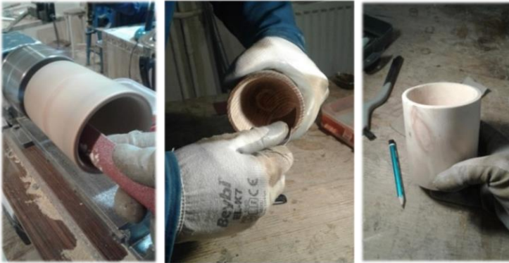
Görsel 15. Zımparalama işlemi ve şekillendirmesi tamamlanmış bardak.
