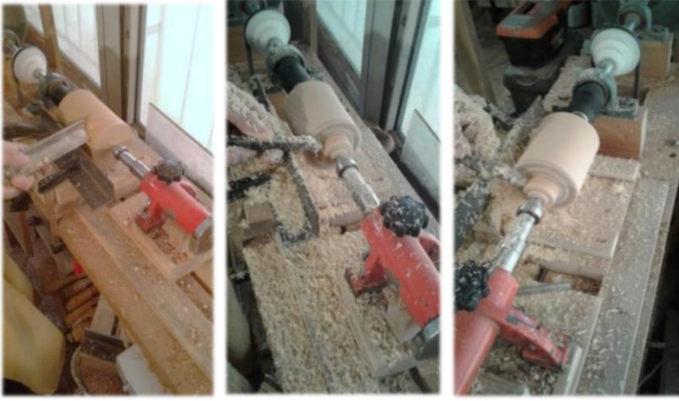
Görsel-11: Parçanın dış kısmının talaşlanarak istenilen ölçülere getirilmesi.
