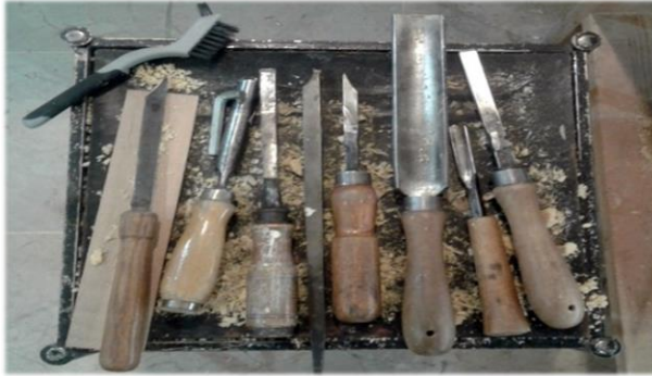
Görsel-9: Tornalamada kullanılan çeşitli torna bıçakları. 4
