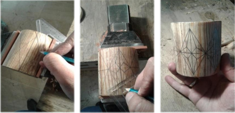
Görsel-20: Çentik oyma yapılacak desen bardak yüzeyine çizilmesi.
