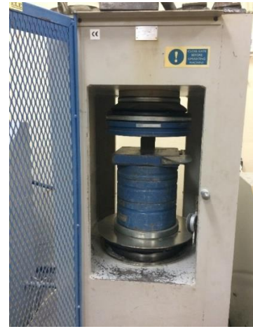
Şekil 6. Tek eksenli basınç dayanımının belirlendiği cihaz
