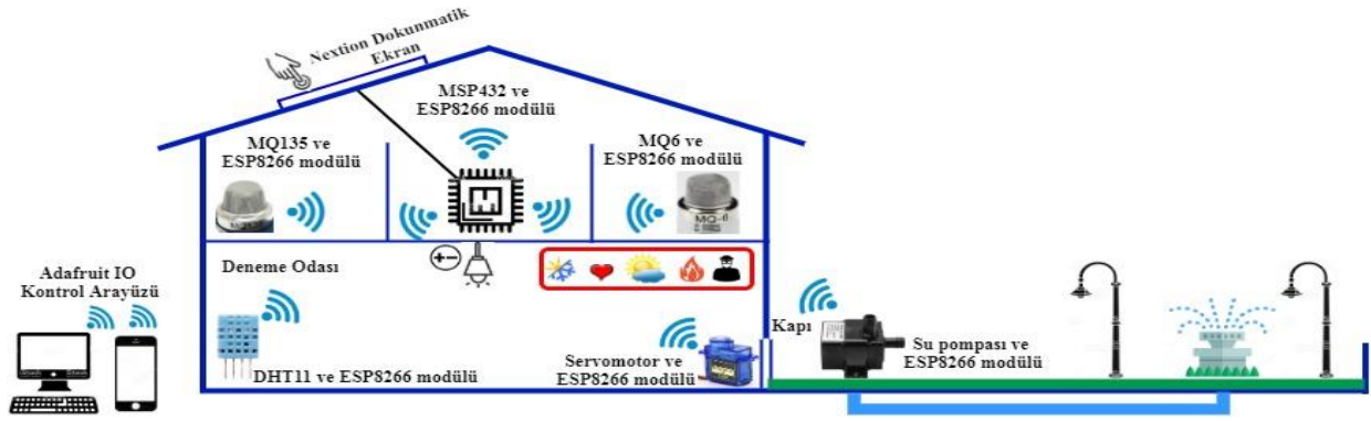
Şekil 1. Tasarlanan kontrol sisteminin genel yapısı
