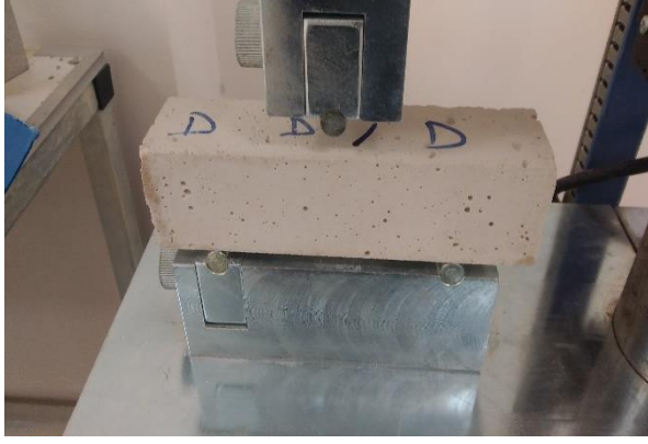
Şekil 5. Sertleşmiş harç deneyi: Eğilme testi
